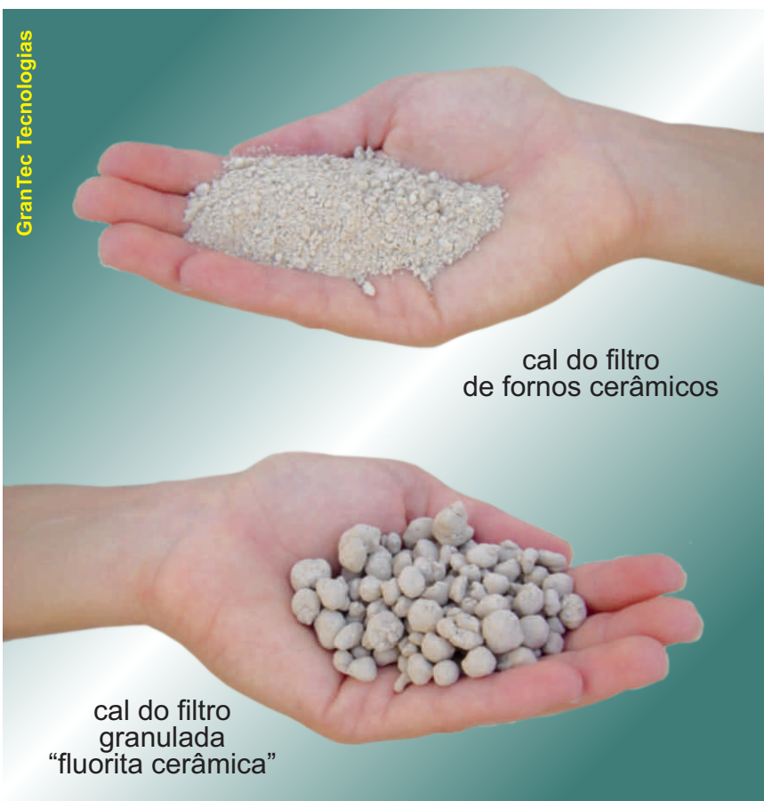
Figura 01. Fluorita cerâmica (cal do filtro de revestimento cerâmico)
